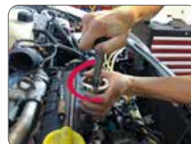
Slaggewicht van 1000 gram voor de zelfs de meest problematische afdichtingen
